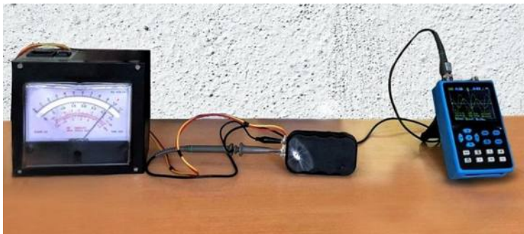
Рис. 1. Лабораторная установка для выявления превышающего уровня помех
