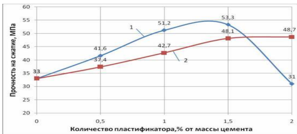
Рис. 1. Зависимость изменения прочности цементного камня на сжатии от количества вводимой добавки: 1 – гиперпластификатор; 2 – суперпластификатор [4].
