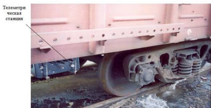
Рис. 6. Технологическая станция, установленная на грузовом вагоне
